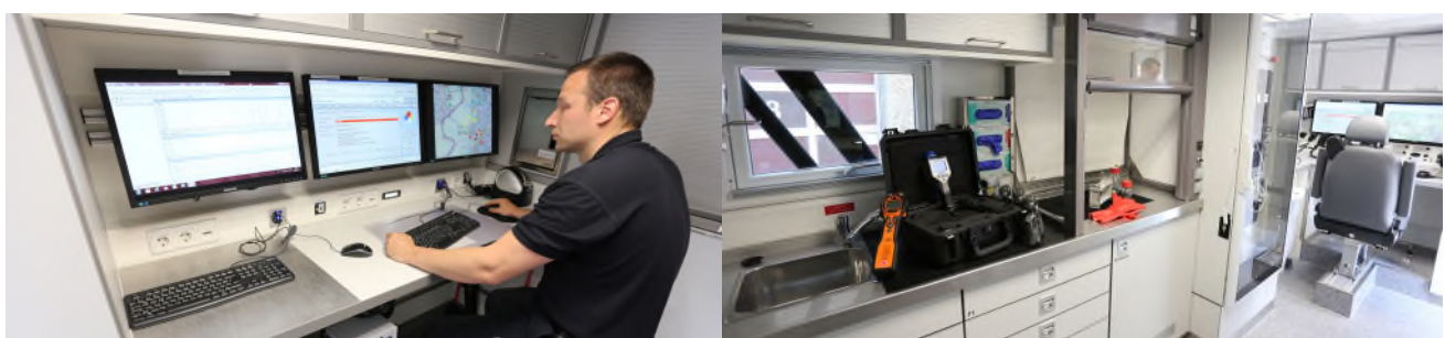
Labor-, PC- und Kommunikationsarbeitsplätze im Innenraum des GW-Mess (Fotos: Feuerwehr Hannover)
