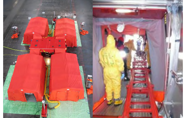
Die Dekontamination findet in vier speziell ausgestatteten Zelten statt, die an den Abrollbehälter angebaute werden. Das Bild rechts zeigt das Schienensystem zur Lagerung von verletzten Personen bei der Dekontamination. (Foto: Feuerwehr Hannover)
