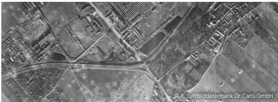
Deuten die Luftbilder auf Blindgängerverdachtspunkte hin, so müssen diese durch technische Sondierungen weiter erforscht werden. Dazu werden Tiefenbohrungen mit einem Durchmesser von 110 mm in einem vorgegebenen Raster um den Verdachtspunkt gebohrt und mittels Magnetfeldsonden überprüft.
