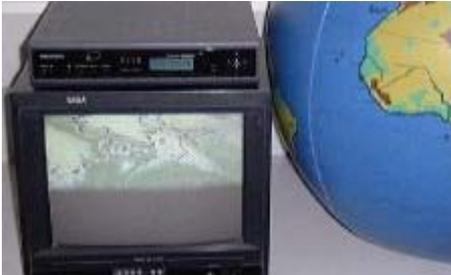
Regelmäßig zur Erde gefunkte Satellitenbilder (Meteosat 7) zeigen die Verteilung und Dynamik der Wolken z.B. über Deutschland. Mit der für Schulen ausleihbaren Anlage (Fernseher, Decoder, Satellitenschüssel) können u.a. mehrere Bilder nacheinander gespeichert werden und anschließend
