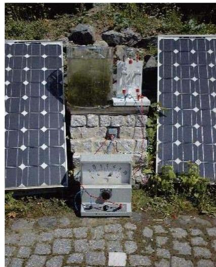
In der Abbildung steht links vom Elektrolysegerät eine mit der Wasserpest (*Elodea canadensis*) besetzte sogenannte Assimilationsglocke. Damit wird der bei der Photosynthese freigesetzte Sauerstoff aufgefangen. Ohne dieses von Tieren und Menschen eingeatmete und in geologischer Urzeit einmal hoch giftige „Abfallprodukt“ der grünen Pflanzen wäre die Nutzung der mit der Nahrung aufgenommenen Energie nicht möglich.
