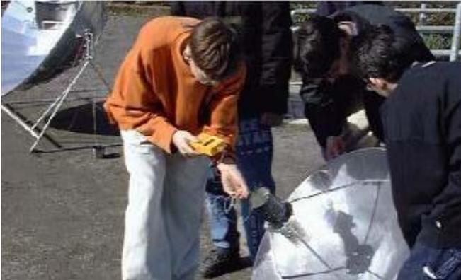
Eine polierte metallene Satellitenschüssel, genau ausgerichtet, bündelt das auf etwa 1,5 m<sup>2</sup> ihrer Fläche fallende Sonnenlicht. Im Brennpunkt wird es so heiß, dass ein hineingehaltener Fidibus aus Zeitungspapier sofort Feuer fängt und das Wasser in der schwarz gefärbten Würstchendose in wenigen Sekunden zu brodeln beginnt. Zwei Frühstückseier sind nach 4 Minuten gerade „richtig“!
