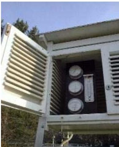
In der Wetterhütte finden Sie Zeigerinstrumente zur Darstellung der Temperatur, der Luftfeuchtigkeit und des Drucks. Ein Trommelschreiber erfasst den Verlauf dieser Werte über jeweils eine Woche. Ein Temperatursensor schickt in kurzen Takten die Werte an einen Datenlogger (Computer) im Unterrichtsgebäude. Hier werden mehrere Temperaturkurven aus mehreren Monaten gespeichert (Raumtemperatur, Warmwassertemperatur, Außentemperatur).
