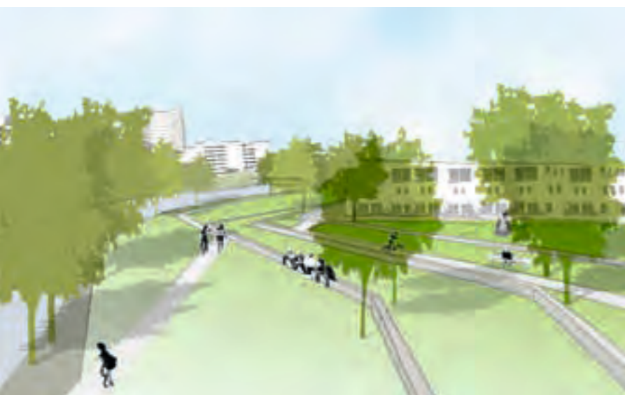
Die Kanten der einzelnen Terrassenstufen können auch zum Verweilen einladen. Der zukünftige Bewuchs wird eher hochstämmig sein, damit im Hochwasserfall das mitgeschwemmte Treibgut nicht so leicht hängen bleibt.
