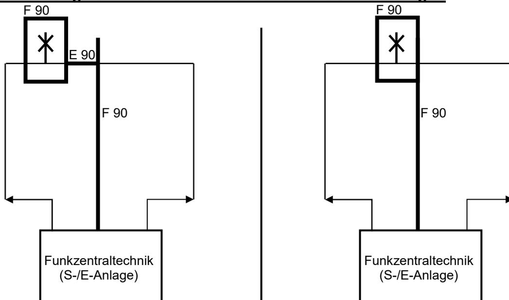
Sobald beide Zuleitungen zu einer Antenne durch den selben, feuerbeständig abgetrennten Bereich verlaufen, sind die Zuleitungen brandschutztechnisch in der Funktionserhaltungsklasse E 90 zu schützen.
