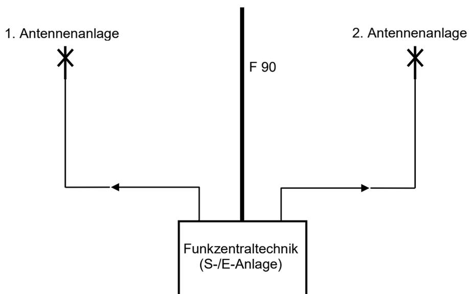
Bei dem Ausfall einer Antennenanlage durch eine Brand- oder mechanische Einwirkung, muss durch die zweite Antennenanlage im benachbarten, feuerbeständig abgetrennten Bereich die Versorgung des geschädigten Bereichs gesichert sein
