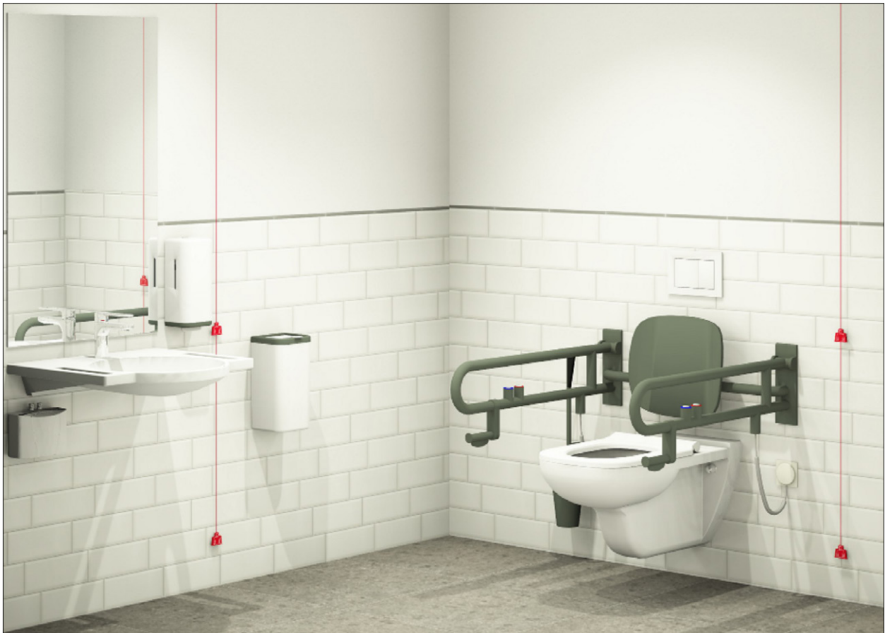
Abbildung 49: Musteransicht zur Ausführung und Anordnung von Zugschnurtastern in einem WC
