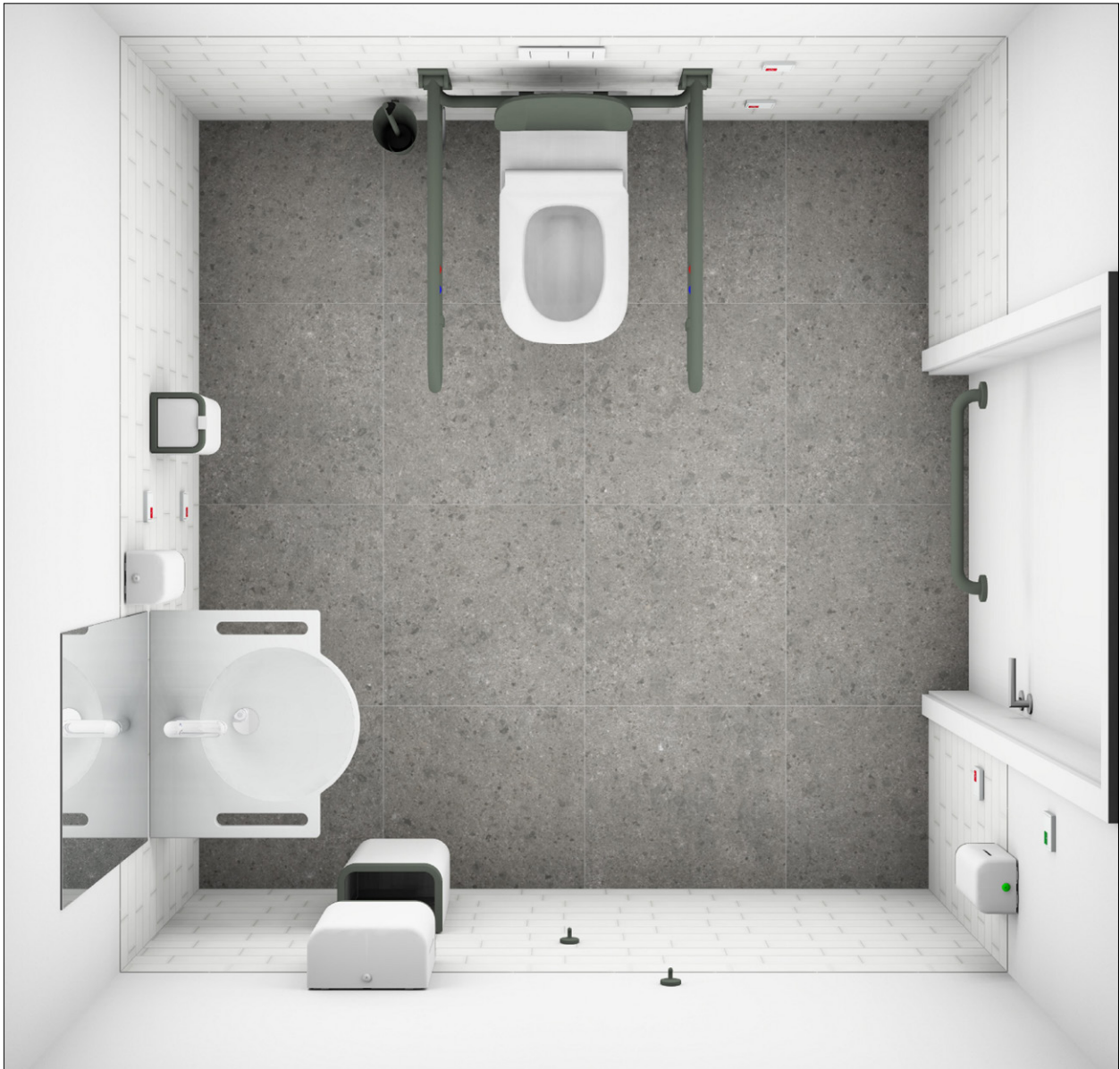
Abbildung 78: Grundriss – Ausführungsbeispiel eines rollstuhlgerechten WC's
