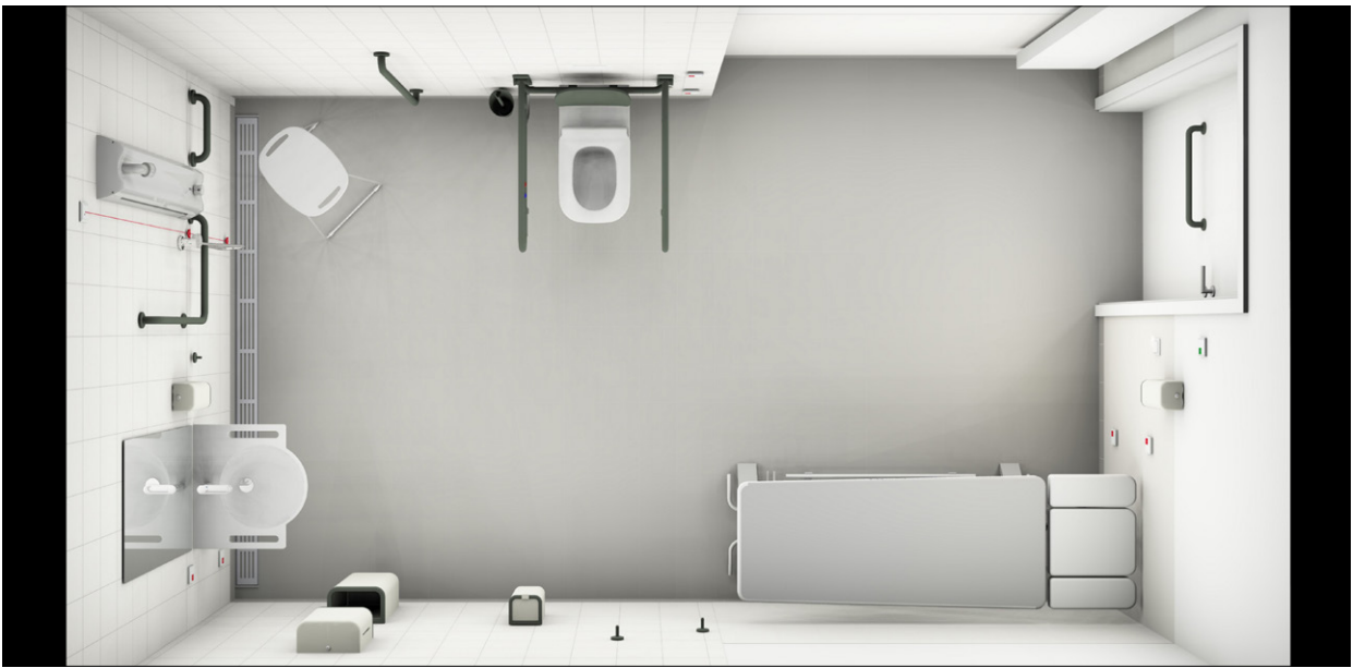
Abbildung 80: Grundriss – Ausführungsbeispiel eines rollstuhlgerechten Dusch-WC's
