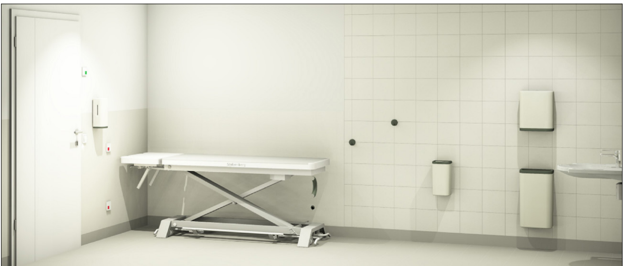
Abbildung 81: Ansicht - Ausführungsbeispiel eines rollstuhlgerechten Dusch-WC's mit Liege
